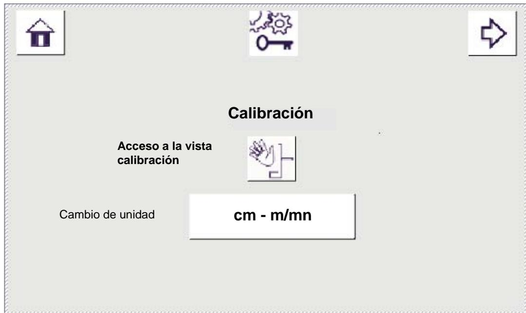
"**Calibración**": este botón permite acceder a la vista calibración de los ejes. En el apoyo de este botón, los robots se detienen y sus ejes son liberados eléctricamente.
